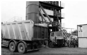
Общая производительность современного комплекса — 60 тонн смеси в час. Старый завод, созданный еще в 80-х годах, выпускал в два раза меньше — порядка 30 тонн. Новая асфальтобетонная установка по своим характеристикам отвечает жесточеным экологическим нормам и требованиям по энергосбережению. Завод может производить любые марки асфальтов, в том числе высокопрочные и износоустойчивые.
